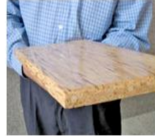
شكل (١٧): ألواح الكونتر والاثاث المدرسي المصنوع من جريد النخيل.
