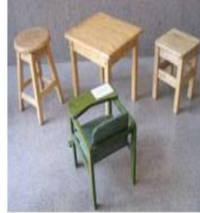
شكل (١٧): ألواح الكونتر والاثاث المدرسي المصنوع من جريد النخيل.
