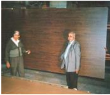
شكل (١٧): ألواح الكونتر والاثاث المدرسي المصنوع من جريد النخيل.
