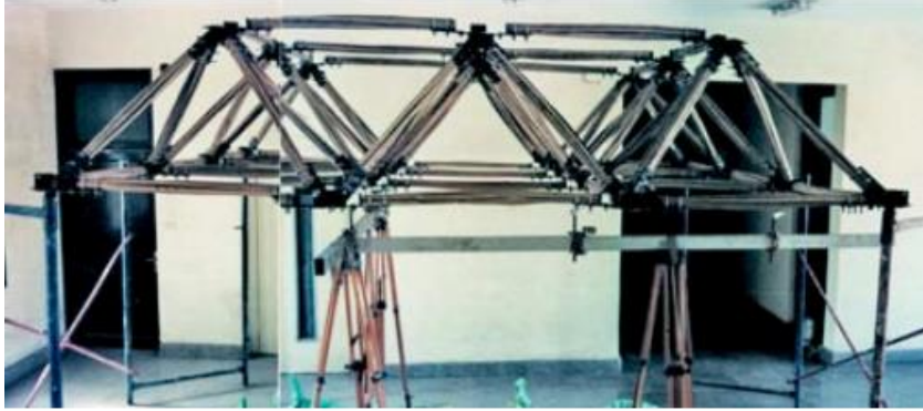
شكل (١٣): النموذج المقترح للتغطية بنظام Space Truss باستخدام جريد النخيل
